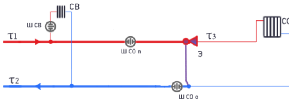
Рисунок 4 – Схема подключения потребителей к двухтрубной тепловой сети (при наличии внутридомовой системы отопления), в качестве регулятора температуры используется элеватор (СО – система отопления, Э – элеватор, СВ – система вентиляции)
